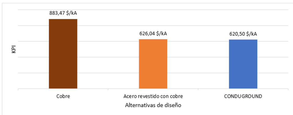
Figura 6. Gráfico del desempeño de las alternativas de diseño
