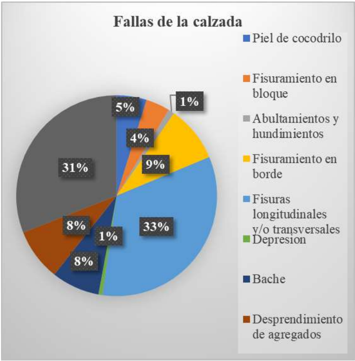
Figura 5. Fallas más recurrentes en el tramo Av. Lago Mara y Plaza de Toros.
