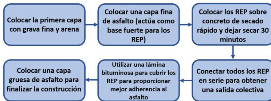
Figura 3. Pasos del proceso de construcción de carreteras piezoeléctricas
