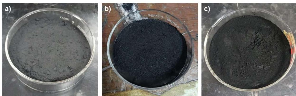
**Figura 1. Carbón activado resultante, a) CA 1 a partir de la tela Franela Tubular, b) CA 2 a partir de la tela Cottone y c) CA Comercial tomado como referencia.**
