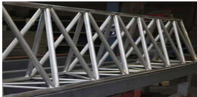
**Figura 10. Viga tipo celosía triangular.**
