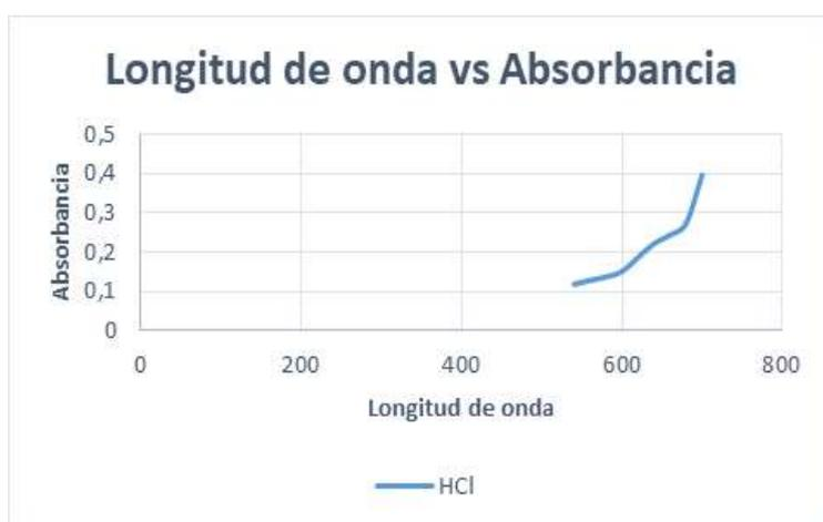
Figura 3. Espectro de absorción para la solución patrón de HCl.
