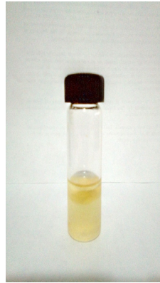
Figura 4. Producto de la transesterificación utilizando KOH como catalizador. (EL Artículo Original no tiene figura 3)
