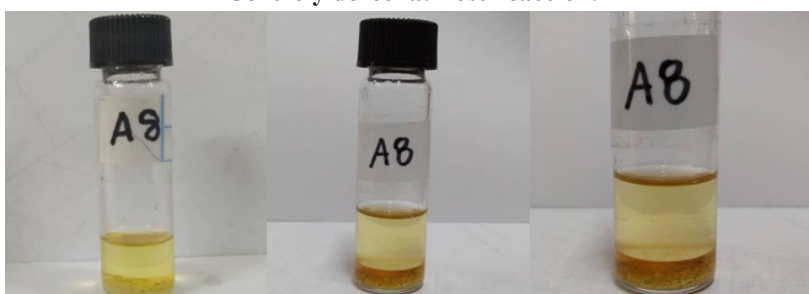
Figura 9. Transesterificación utilizando arcilla STx-1b impregnada con KOH. Izquierda: Pre-reacción. Centro y derecha: Post-reacción.
