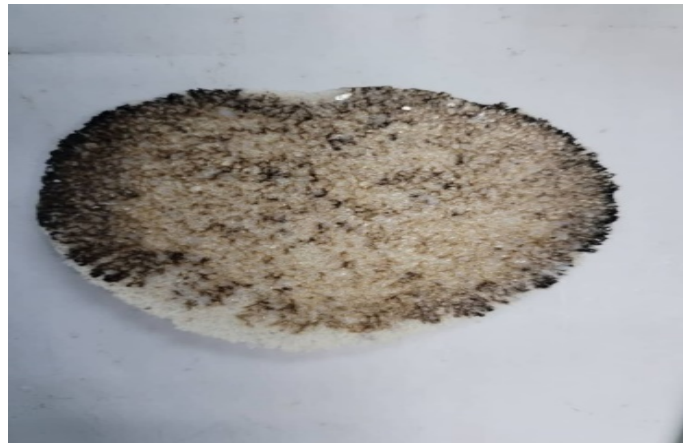
Figura 17. Placa fundida de la Mezcla PET 70% y 30% HPMC 180 °C.
