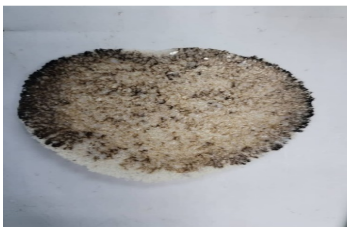
Figura 17. Placa fundida de la Mezcla PET 70% y 30% HPMC 180 °C.
