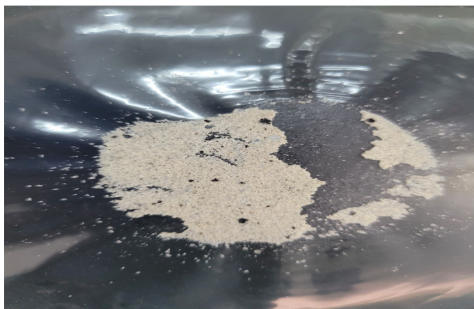
Figura 16. Placa fundida de la Mezcla PET 95% y 5% HPMC a 220°C de referencia.
