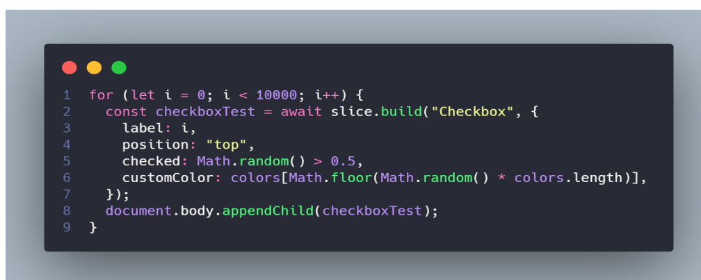
Figura 15. Código utilizado para la creación masiva de componentes para la prueba de estrés.
