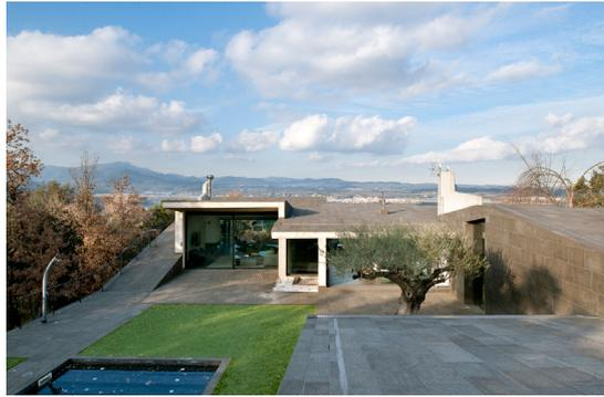
**Figura 6. La VARS House en Madrid, los espacios de servicio se semi-enterraron y solo sobresalió la plataforma superior, cuya silueta sigue la topografía del terreno [6]**
