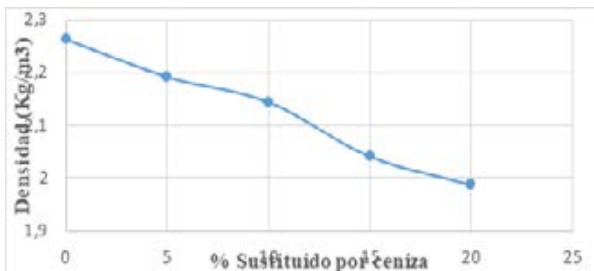
Figura 4. Densidad de mezcla en función del % sustituido
