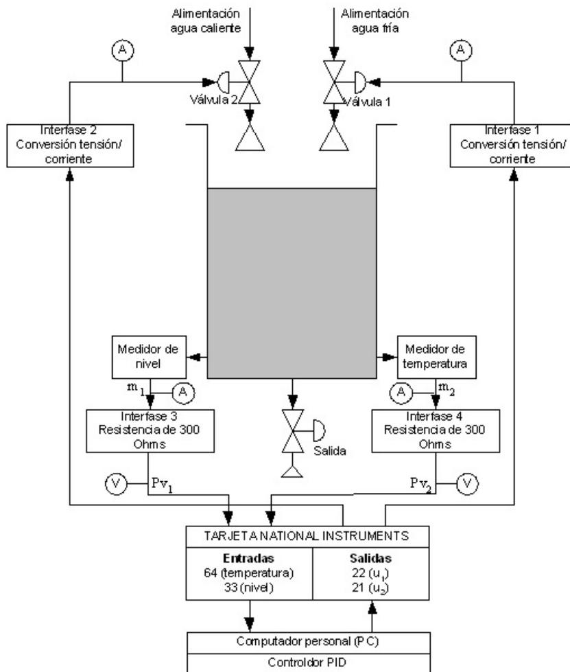
**Figura 2 : Representación del sistema de control.**
